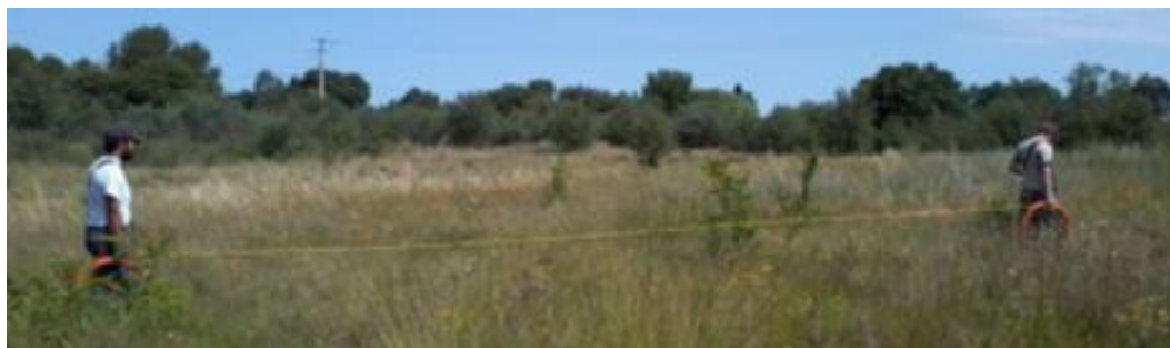
Photographie 1 – EM34 en mode dipôle horizontal, espacement inter-bobines de 10m.
